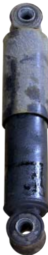
Bild 2: Stötdämpare blöt p g a oljeläckage. Dämpare behöver bytas ut.
