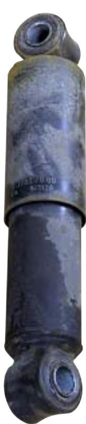
Bild 1: Stötdämpare med oljefuktat ytterrör. Dämpare ok.
