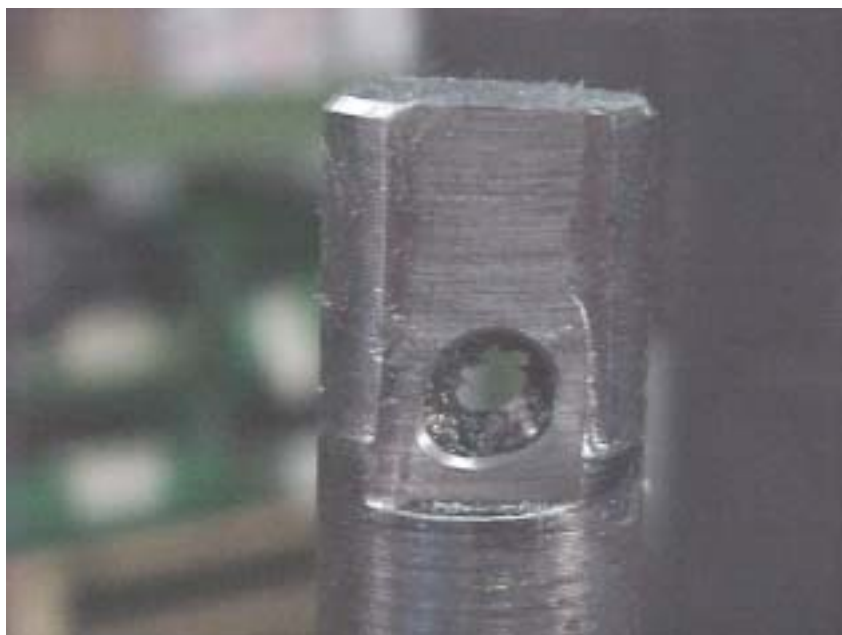
Bild 3: Tryckmärken på spindelhalsen och deformation av borrhålet
