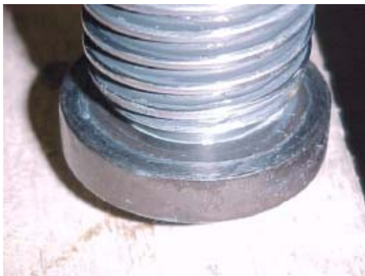
Bild 4: Repor på den undre anläggningsbrickan
