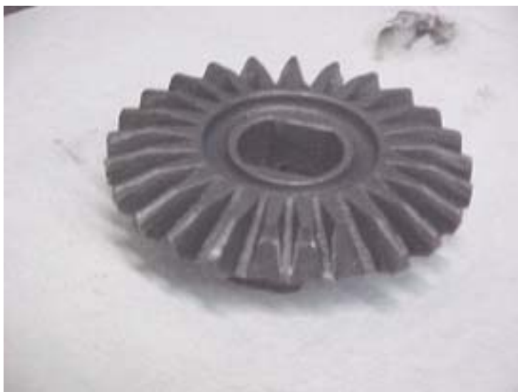
Bild 5: Avbrutna tänder på kugghjul
