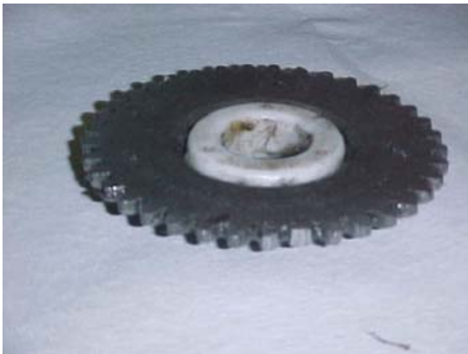
Bild 1: Skadad kuggkrans (snabbväxel)
