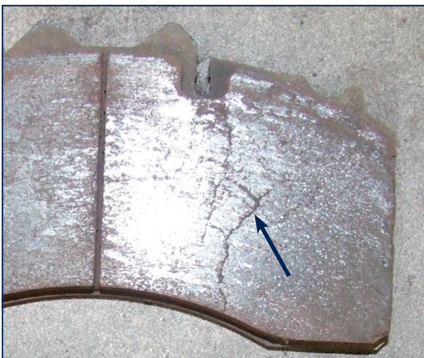
Illustration 4 : Fissures à la surface de la garniture dans une zone admissible
