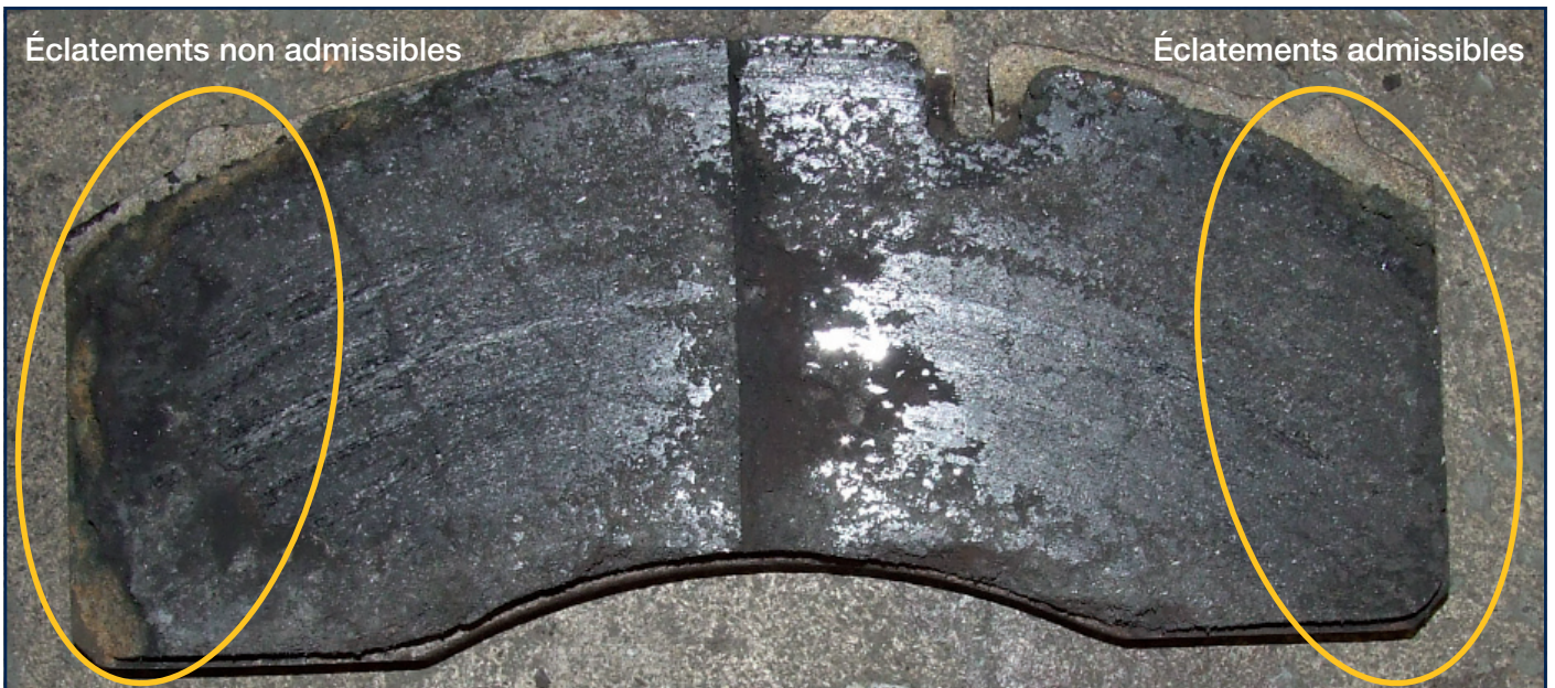
Illustration 3 : Garniture avec éclatements non admissibles
