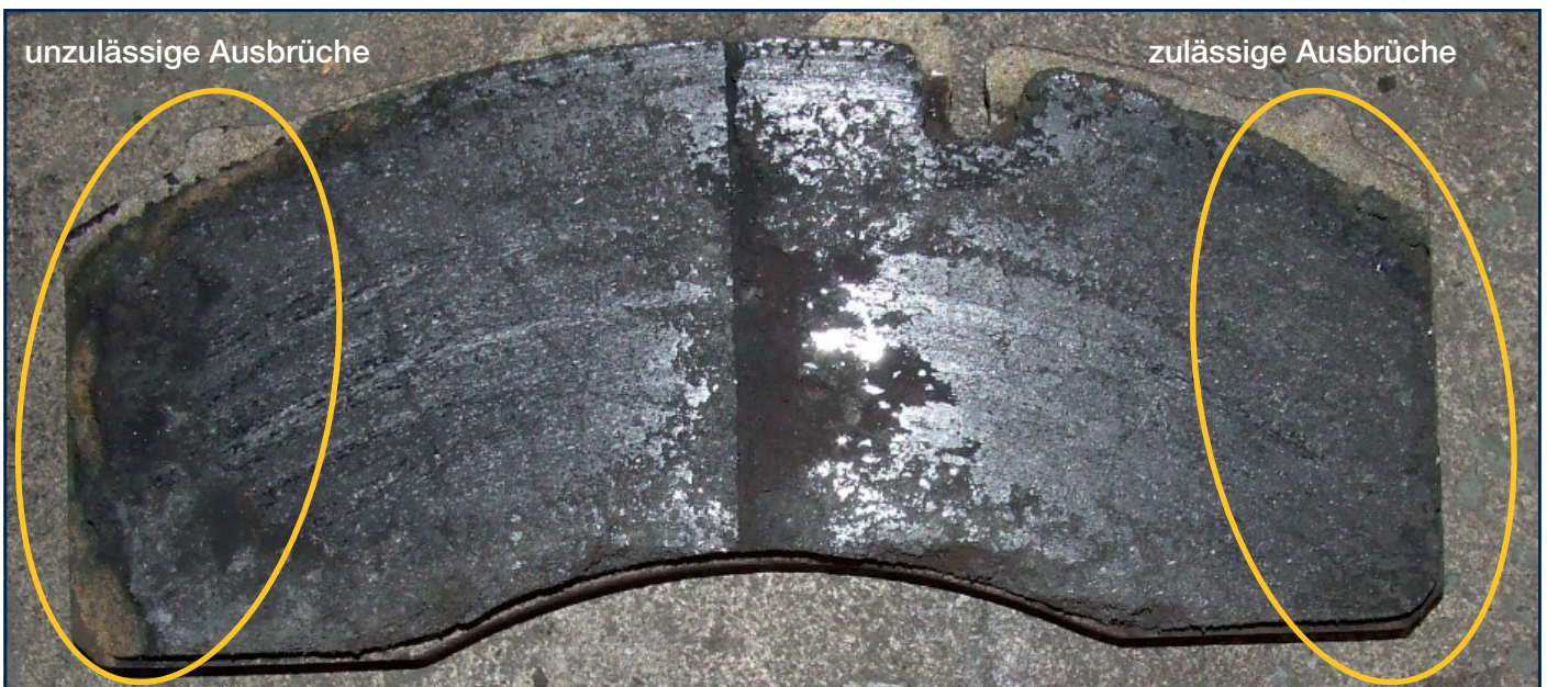
Bild 3: Belag mit unzulässigen Ausbrüchen
