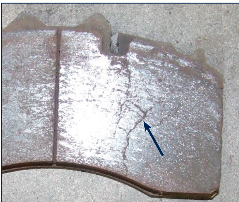
Bild 4: Risse in der Belagoberfläche im zulässigen Bereich
