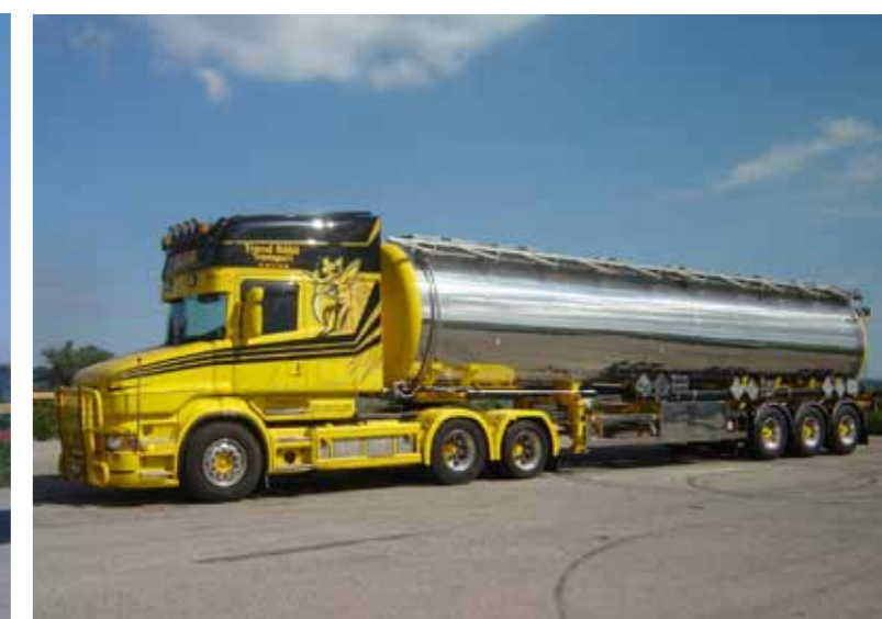
En norsk T-Scania med en Tankmobil-trailer av typen ST3 LR 342 för transport av kemikalier. Trippeln är en 24-tons med sista axeln medspårande. Ekipaget tillhör Trond Råkil Transport i Norge och levererades i juni 2010.
